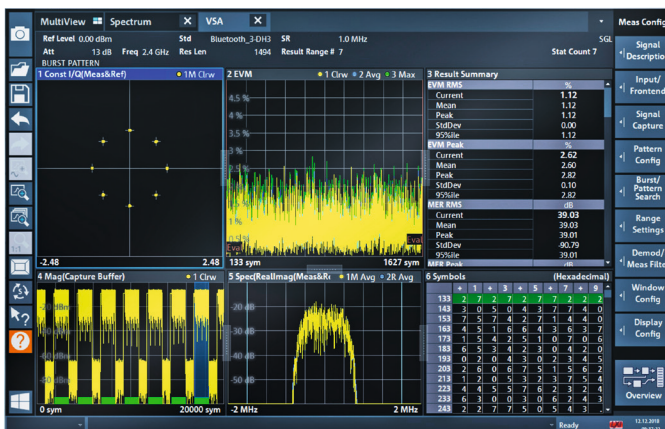
Demodulación de una señal de Bluetooth® con la opción R&S®FPL1-K70
