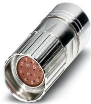
电缆连接器，直头，螺钉锁紧，M23，位数：17，触点类型：孔式插头，屏蔽：有，保护等级：IP67，电缆直径范围：5 mm ... 13.2 mm，位数：17，接线方式：压接，系列：RF，根据RoHS II指令（不含豁免条款6c，即铅含量<0.1%），本产品预计自2026年第三季度起实现无铅化；如需提前获得无铅替代品，可应要求提供
