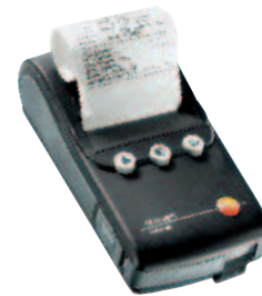
Dokumentation der Messwerte direkt vor Ort
