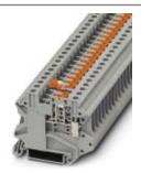
Bloc de jonction à couteau de sectionnement, tension nominale: 500 V, intensité nominale: 20 A, type de raccordement: Raccordement vissé, section: 0,14 mm² - 6 mm², AWG: 26 - 10, longueur: 57,8 mm, largeur: 6,2 mm, coloris: gris, montage: NS 35/7,5, NS 35/15
