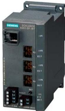
SCALANCE X201-3PIRT managed IE IRT Switch, 1x 10/100 Mbit/s RJ45 Ports, 3x 100 Mbit/s POF SC RJ Ports, Fehlermeldekontakt mit Set- Taster, redundante Spannungs- Versorgung, PROFINET IO Device, Netzwerk-Management, Redundanz-Manager integriert, inkl. elektron. Handbuch auf CD-ROM, C-PLUG optional.
