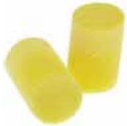
Les bouchons d'oreille en mousse compressible reprennent leur forme initiale avec lenteur. Une fois dans l'oreille, ils se dilatent et s'adaptent à la forme du conduit auditif pour assurer sécurité et confort. Ce type de bouchon doit être jeté après chaque usage et est disponible sous forme d'unités ou de paires raccordées.
