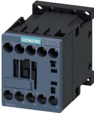
Leistungsschütz, AC-3, 12 A, 5,5 kW / 400 V, 4-polig, DC 24 V, Hauptkontakte: 2 S + 2 Ö, Schraubanschluss, Baugröße: S00
