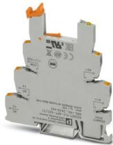
6,2 mm PLC-Grundklemme mit Push-in-Anschluss, ohne Relais- oder Solid-State-Relaisbestückung, zur Montage auf Tragschiene NS 35/7,5, 1 Wechsler, Eingangsspannung 5 V DC
