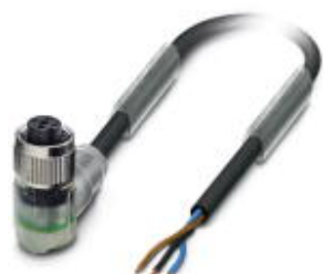
センサ/アクチュエータケーブル, 3-極, PUR ハロゲンフリー, 黒-灰RAL 7021, 片側フリー, 上 ソケット アングル M12, Aコーディング, あり LED 2点, ケーブル長: 10 m
