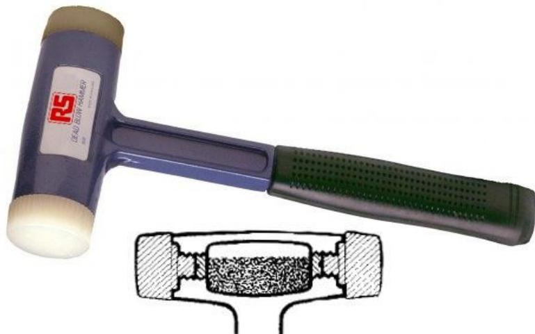
Estos martillos de maza de goma tienen un cabezal presofundido con revestimiento y un mango de aleación de aluminio con empuñadura de caucho para absorber el impacto.
