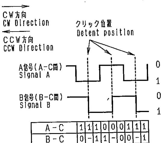
A相の状態が変化した時にカウントし、CW, CCWの判定はその時のB相の状態による。
