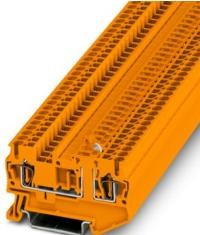
刀闸分断接线端子，标称工作电压: 400 V，额定电流: 20 A，接线方式: 回拉式弹簧连接，额定接线容量: 2.5 mm<sup>2</sup>，接线容量: 0.08 mm<sup>2</sup> - 4 mm<sup>2</sup>，安装: NS 35/7,5，NS 35/15，颜色: 橙色
