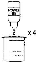
10. A l'aide de la pipette 1 ml, ajoutez goutte à goutte le réactif "Thiosulfate". Mélangez après chaque goutte et comptez le nombre de gouttes ajoutées jusqu'à ce que la solution devienne limpide.
