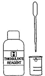
La teneur en mg/l de chlore correspond au nombres de gouttes rajoutées x 0,2 : **Nbr. de gouttes x 0,2 = mg/l de chlore.**
