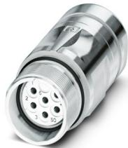
M23，耦合连接器，系列: CA，直头，屏蔽: 有，用于标准和SPEEDCON连锁，位数: 6，旋转方向: 标准，触点类型: 孔式插头，焊接，电缆直径范围: 3 mm ... 14.5 mm，编码: N，根据RoHS II指令（不含豁免条款6c，即铅含量<0.1%），本产品预计自2026年第一季度起实现无铅化；如需提前获得无铅替代品，可应要求提供
