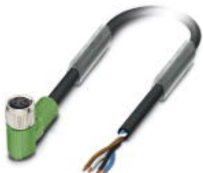
センサ/アクチュエータケーブル, 4-極, PUR ハロゲンフリー, 黒-灰RAL 7021, 片側フリー, 上 ソケット アングル M8, ケーブル長: 5 m
