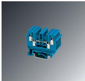
直通式接线端子，标称工作电压: 500 V，额定电流: 24 A，接线方式: 螺钉连接，额定接线容量: 2.5 mm<sup>2</sup>，横截面: 0.2 mm<sup>2</sup> - 4 mm<sup>2</sup>，安装方式: NS 35/7,5，NS 35/15，NS 32，颜色: 蓝色
