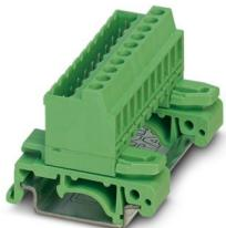
DIN导轨连接器，额定横截面: 2.5 mm<sup>2</sup>，颜色: 绿色，额定电流: 12 A，额定电压(III/2): 320 V，触点表面: Sn，触点类型: 针式插头，电位数: 24，行数: 1，位数: 24，连接量: 24，产品系列: UMSTBVK 2,5/-G，针距: 5.08 mm，接线方式: 带压片的螺钉连接，螺钉头规格: L 开槽，导线/PCB连接方向: 0 °，每个电势的焊针数量: 1，插拔系统: COMBICON MSTB 2,5，互锁: 不带，安装方式: 不带，包装类型: 纸箱包装
