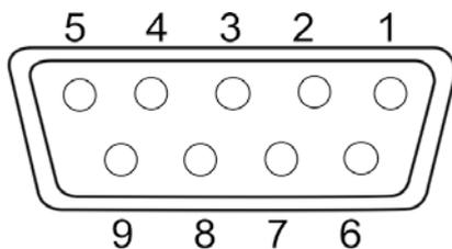
Fig. : Connettore in miniatura D-sub a 9 pin
