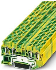
接地端子，连接量: 4，接线方式: 回拉式弹簧连接，横截面: 0.08 mm<sup>2</sup> - 4 mm<sup>2</sup>，安装方式: NS 35/7,5，NS 35/15，颜色: 黄绿相间
