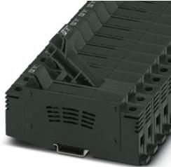
保险丝接线端子，保险丝类型: 玻璃 / 陶瓷 / ...，保险丝类型: gG / gPV / 10.3 x 85，标称工作电压: 1500 V DC，额定电流: 32 A，位数: 1，接线方式: 螺钉连接，额定接线容量: 16 mm<sup>2</sup>，接线容量: 2.5 mm<sup>2</sup> - 25 mm<sup>2</sup>，安装方式: NS 35/7,5，NS 35/15，颜色: 黑色
