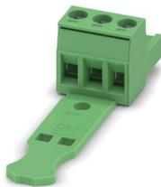
PCB插拔式连接器，额定横截面: 2.5 mm<sup>2</sup>，颜色: 绿色，额定电流: 12 A，额定电压(III/2): 320 V，触点表面: Sn，触点类型: 孔式插头，电位数: 3，行数: 1，位数: 3，连接量: 3，产品系列: MSTB 2,5/..-ST，针距: 5.08 mm，接线方式: 带压片的螺钉连接，螺钉头规格: L 开槽，导线 / PCB连接方向: 0°，锁扣: - 锁扣，插拔系统: COMBICON MSTB 2,5，互锁: 不带，安装方式: 不带，包装类型: 纸箱包装，抗外力保护装置 (STZ11)
