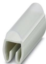
Ader-Bezeichnungsträger, transparent, unbeschriftet, Kabeldurchmesserbereich: 2,8 ... 4,4 mm, Montageart: aufclipsen, Textfeldhöhe: 4 mm, Textfeldbreite: 18 mm
