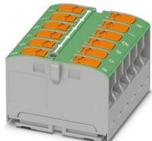
接线板，标称工作电压: 450 V，额定电流: 24 A，连接量: 12，位数: 1，接线方式: 直插式连接，额定接线容量: 2.5 mm<sup>2</sup>，横截面: 0.14 mm<sup>2</sup> - 4 mm<sup>2</sup>，安装方式: 用于卡接在DIN导轨适配器上，直接安装，带法兰，自由悬挂，颜色: 绿色
