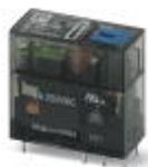
Relais miniature enfichable, avec contact multicouches plaqué or, 2 contacts inverseurs, touche de test, affichage mécanique de position, voyant d'état, diode de roue libre, polarité A1+, A2-, tension d'entrée 24 V DC
