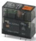
Relais miniature enfichable, avec contact multicouches plaque or, 1 contact inverseur, touche de test, affichage mécanique de position, voyant d'état, tension d'entrée 230 V AC
