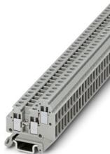
微型端子，标称工作电压: 400 V，额定电流: 17.5 A，接线方式: 螺钉连接，额定接线容量: 1.5 mm<sup>2</sup>，横截面: 0.14 mm<sup>2</sup> - 1.5 mm<sup>2</sup>，安装方式: NS 15，颜色: 灰色
