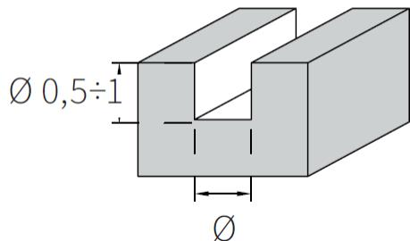
Grafico di utilizzo della fresa frontale, con il dettaglio delle profondità di lavorazione consigliate per fresatura di cave.
