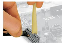
Raccordement des conducteurs, avec outil de manipulation
