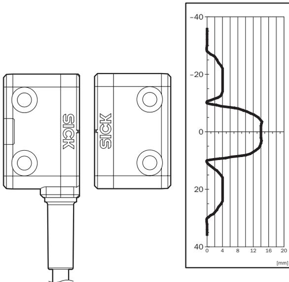
Gesicherter Einschaltabstand  $S_{A0}$  10 mm. Randbereiche bei paralleler Annäherung beachten: Wenn sich der Betätiger seitlich zur Sensorfläche bewegt, muss ein Mindestabstand von 6 mm eingehalten werden. Dies verhindert ein zu frühzeitiges Auslösen aufgrund der seitlichen Ansatzbereiche.
