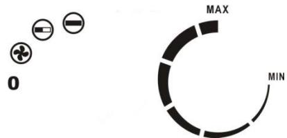
**4.1 Linker Drehknopf:** Wahlschalter mit Heizstufen
