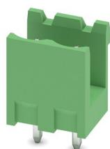
プリント基板用ソケット、定格接続サイズ: 2.5 mm<sup>2</sup>、色: 緑、定格電流: 12 A、定格電圧 ( II/2 ): 320 V、コンタクト表面: すず、コンタクトタイプ: ピン、電位の数: 2、列の数: 1、極数: 2、接続数: 2、製品ラインアップ: MSTBV 2,5/..G、ピッチ: 5.08 mm、取付け方法: ウエーブはんだ付け、ピン配列: 直線的なピン配置、はんだピン [P]: 3.9 mm、電位あたりのはんだピンの数: 1、プラグインシステム: COMBICON MSTB 2,5、はんだピン方向: 規格、嵌合ロック: なし、取付け方法: なし、梱包の種類: 段ボール梱包
