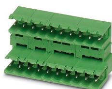
プリント基板用ソケット、定格接続サイズ: 2.5 mm<sup>2</sup>、色: 緑、定格電流: 10 A、定格電圧 ( II/2 ): 320 V、コンタクト表面: すず、コンタクトタイプ: ピン、電位の数: 4、列の数: 2、極数: 2、接続数: 4、製品ラインアップ: MDSTB 2,5/..-G、ピッチ: 5.08 mm、取付け方法: ウエーブはんだ付け、ピン配列: 直線的なピン配置、はんだピン [P]: 3.2 mm、電位あたりのはんだピンの数: 1、プラグインシステム: COMBICON MSTB 2,5、はんだピン方向: 規格、嵌合ロック: なし、取付け方法: なし、梱包の種類: 段ボール梱包、次の点に注意。取付けフランジ: 製品番号: 1736771, 1736768。MVSTBまたはFKCVプラグと組合せる場合、MVSTBW ( またはFKCVW ) およびMVSTBRプラグ ( またはFKCVR ) の両方を使用する必要があります。TMSTBPプラグと組合せることはできません。
