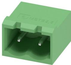
プリント基板用ソケット、定格接続サイズ: 2.5 mm<sup>2</sup>、色: 緑、定格電流: 12 A、定格電圧 ( II/2 ): 320 V、コンタクト表面: すず、コンタクトタイプ: ピン、電位の数: 2、列の数: 1、極数: 2、接続数: 2、製品ラインアップ: MSTBA 2,5/..G、ピッチ: 5.08 mm、取付け方法: ウエーブはんだ付け、ピン配列: 直線的なピン配置、はんだピン [P]: 3.5 mm、電位あたりのはんだピンの数: 1、プラグインシステム: COMBICON MSTB 2,5、はんだピン方向: 規格、嵌合ロック: なし、取付け方法: なし、梱包の種類: 段ボール梱包
