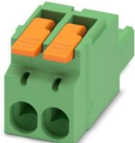
プリント基板用コネクタ、定格接続サイズ: 2.5 mm<sup>2</sup>、色: 緑、定格電流: 16 A、定格電圧 (III/2): 320 V、コンタクト表面: すず、コンタクトタイプ: メス、列の数: 1、極数: 2、製品ラインアップ: LPC 2,5/-ST、ピッチ: 5.08 mm、接続方式: レバー操作型Push-in接続式、電線/プリント基板の接続方向: 0 °、固定クリップ: - 固定クリップ、プラグインシステム: COMBICON MSTB 2,5、嵌合ロック: なし、取付け方法: なし、梱包の種類: 段ボール梱包
