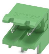
プリント基板用ソケット、定格接続サイズ: 2.5 mm<sup>2</sup>、色: 緑、定格電流: 12 A、定格電圧 ( II/2 ): 320 V、コンタクト表面: すず、コンタクトタイプ: ピン、電位の数: 2、列の数: 1、極数: 2、接続数: 2、製品ラインアップ: MSTBW 2,5/..-G、ピッチ: 5.08 mm、取付け方法: ウエーブはんだ付け、ピン配列: 直線的なピン配置、はんだピン [P]: 3.5 mm、電位あたりのはんだピンの数: 1、プラグインシステム: COMBICON MSTB 2,5、はんだピン方向: 規格、嵌合ロック: なし、取付け方法: なし、梱包の種類: 段ボール梱包
