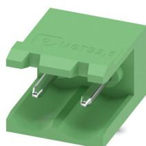
プリント基板用ソケット、定格接続サイズ: 2.5 mm<sup>2</sup>、色: 緑、定格電流: 12 A、定格電圧 ( III/2 ): 320 V、コンタクト表面: すず、コンタクトタイプ: ピン、電位の数: 2、列の数: 1、極数: 2、接続数: 2、製品ラインアップ: MSTB 2,5/..-G、ピッチ: 5.08 mm、取付け方法: ウエーブはんだ付け、ピン配列: 直線的なピン配置、はんだピン [P]: 3.5 mm、電位あたりのはんだピンの数: 1、プラグインシステム: COMBICON MSTB 2,5、はんだピン方向: 規格、嵌合ロック: なし、取付け方法: なし、梱包の種類: 段ボール梱包
