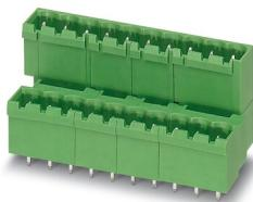
プリント基板用ソケット、定格接続サイズ: 2.5 mm<sup>2</sup>、色: 緑、定格電流: 10 A、定格電圧 ( II/2 ): 320 V、コンタクト表面: すず、コンタクトタイプ: ピン、電位の数: 4、列の数: 2、極数: 2、接続数: 4、製品ラインアップ: MDSTBVA 2,5/..-G、ピッチ: 5.08 mm、取付け方法: ウエーブはんだ付け、ピン配列: 直線的なピン配置、はんだピン [P]: 3.9 mm、電位あたりのはんだピンの数: 1、プラグインシステム: COMBICON MSTB 2,5、はんだピン方向: 規格、嵌合ロック: なし、取付け方法: なし、梱包の種類: 段ボール梱包、製品を配置してさまざまな極数を作成可能です。MVSTBまたはFKCVプラグコンポーネントと組合せる場合、MVSTBW ( またはFKCVW ) およびMVSTBRプラグ ( またはFKCVR ) の両方を使用する必要があります。TMSTBPプラグコンポーネントと組合せることはできません。
