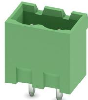
プリント基板用ソケット、定格接続サイズ: 2.5 mm<sup>2</sup>、色: 緑、定格電流: 12 A、定格電圧 ( II/2 ): 320 V、コンタクト表面: すず、コンタクトタイプ: ピン、電位の数: 2、列の数: 1、極数: 2、接続数: 2、製品ラインアップ: MSTBVA 2,5/..-G、ピッチ: 5.08 mm、取付け方法: ウエーブはんだ付け、ピン配列: 直線的なピン配置、はんだピン [P]: 3.9 mm、電位あたりのはんだピンの数: 1、プラグインシステム: COMBICON MSTB 2,5、はんだピン方向: 規格、嵌合ロック: なし、取付け方法: なし、梱包の種類: 段ボール梱包
