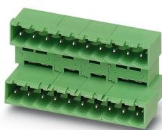
プリント基板用ソケット、定格接続サイズ: 2.5 mm<sup>2</sup>、色: 緑、定格電流: 10 A、定格電圧 ( II/2 ): 320 V、コンタクト表面: すず、コンタクトタイプ: ピン、電位の数: 4、列の数: 2、極数: 2、接続数: 4、製品ラインアップ: MDSTBA 2,5/..-G、ピッチ: 5.08 mm、取付け方法: ウエーブはんだ付け、ピン配列: 直線的なピン配置、はんだピン [P]: 3.2 mm、電位あたりのはんだピンの数: 1、プラグインシステム: COMBICON MSTB 2,5、はんだピン方向: 規格、嵌合口ツク: なし、取付け方法: なし、梱包の種類: 段ボール梱包、製品を配置してさまざまな極数を作成可能です。MVSTBまたはFKCVBプラグコンポーネントと組合せる場合、MVSTBW ( またはFKCVW ) およびMVSTBRプラグ ( またはFKCVR ) の両方を使用する必要があります。TMSTBPプラグコンポーネントと組合せることはできません。
