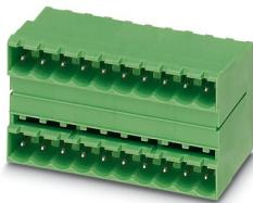
プリント基板用ソケット、定格接続サイズ: 2.5 mm<sup>2</sup>、色: 緑、定格電流: 10 A、定格電圧 ( II/2 ): 320 V、コンタクト表面: すず、コンタクトタイプ: ピン、電位の数: 4、列の数: 2、極数: 2、接続数: 4、製品ラインアップ: MDSTB 2,5/..-G1、ピッチ: 5.08 mm、取付け方法: ウエーブはんだ付け、ピン配列: 直線的なピン配置、はんだピン [P]: 3.5 mm、電位あたりのはんだピンの数: 1、プラグインシステム: COMBICON MSTB 2,5、はんだピン方向: 規格、嵌合口ツク: なし、取付け方法: なし、梱包の種類: 段ボール梱包、MVSTBまたはFKCVBプラグコンポーネントと組合せる場合、MVSTBW ( またはFKCVW ) およびMVSTBRプラグ ( またはFKCVR ) の両方を使用する必要があります。TMSTBPプラグコンポーネントと組合せることはできません。
