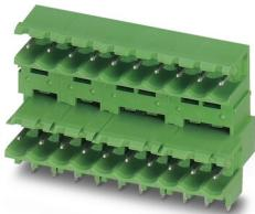
プリント基板用ソケット、定格接続サイズ: 2.5 mm<sup>2</sup>、色: 緑、定格電流: 10 A、定格電圧 ( III/2 ): 320 V、コンタクト表面: すず、コンタクトタイプ: ピン、電位の数: 4、列の数: 2、極数: 2、接続数: 4、製品ラインアップ: MDSTBW 2,5/..-G、ピッチ: 5.08 mm、取付け方法: ウエーブはんだ付け、ピン配列: 直線的なピン配置、はんだピン [P]: 3.8 mm、電位あたりのはんだピンの数: 1、プラグインシステム: COMBICON MSTB 2,5、はんだピン方向: 規格、嵌合ロック: なし、取付け方法: なし、梱包の種類: 段ボール梱包、製品を配置してさまざまな極数を作成可能です。MVSTBまたはFKCVプラグコンポーネントと組合せる場合、MVSTBW ( またはFKCVW ) およびMVSTBRプラグ ( またはFKCVR ) の両方を使用する必要があります。TMSTBPプラグコンポーネントと組合せることはできません。
