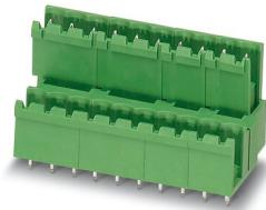
プリント基板用ソケット、定格接続サイズ: 2.5 mm<sup>2</sup>、色: 緑、定格電流: 10 A、定格電圧 ( II/2 ): 320 V、コンタクト表面: すず、コンタクトタイプ: ピン、電位の数: 4、列の数: 2、極数: 2、接続数: 4、製品ラインアップ: MDSTBV 2,5/..-G、ピッチ: 5.08 mm、取付け方法: ウエーブはんだ付け、ピン配列: 直線的なピン配置、はんだピン [P]: 3.5 mm、電位あたりのはんだピンの数: 1、プラグインシステム: COMBICON MSTB 2,5、はんだピン方向: 規格、嵌合ロック: なし、取付け方法: なし、梱包の種類: 段ボール梱包、次の点に注意。取付けフランジ: 製品番号: 1836477、1836480。MVSTBまたはFKCVプラグコンポーネントと組合せる場合、MVSTBW ( またはFKCVW ) およびMVSTBRプラグ ( またはFKCVR ) の両方を使用する必要があります。TMSTBPプラグコンポーネントと組合せることはできません。
