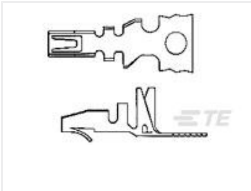
TE Part #3-794121-1 TERMINAL, MINI AMP-IN 2000 22-18 AWG
