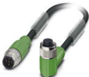
センサ/アクチュエータケーブル, 5-極, PUR ハロゲンフリー, 黒-灰RAL 7021, シールド対応, プラグ ストレー ト M12, Aコーディング, 上 ソケット アングル M12, Aコーディング, ケーブル長: 0.3 m
