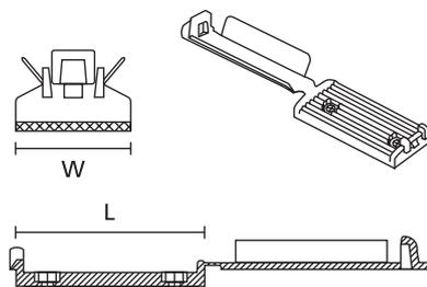
Kabelhalter für Flachbandkabel
