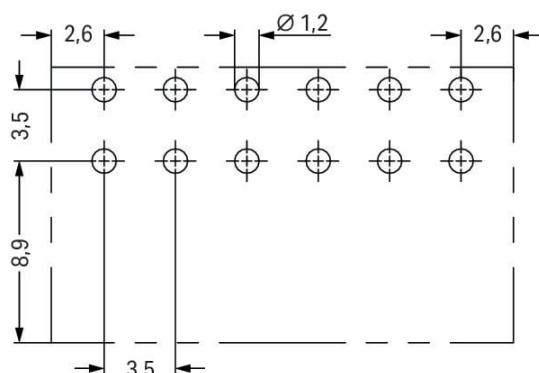
Connecteur mâle série 713 avec dimensions de la goupille de soudage 0,8 x 0,8 mm
