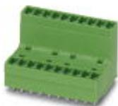
Leiterplattengrundleiste, Nennstrom: 8 A, Polzahl: 12, Rastermaß: 3,81 mm, Farbe: grün, Kontaktoberfläche: Zinn, Montage: Wellenlöten, Bei Kombination mit MCV-Steckerteilen ist jeweils ein MCVW- und ein MCVR-Stecker zu verwenden.
