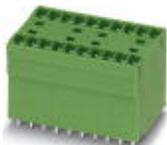
Leiterplattengrundleiste, Nennstrom: 8 A, Polzahl: 12, Rastermaß: 3,81 mm, Farbe: grün, Kontaktoberfläche: Zinn, Montage: Wellenlöten, Bei Kombination mit MCV-Steckerteilen ist jeweils ein MCVW- und ein MCVR-Stecker zu verwenden.
