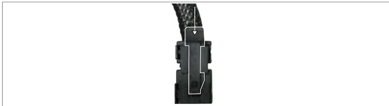
Figure 148: Unlocking the mini I/O connector
