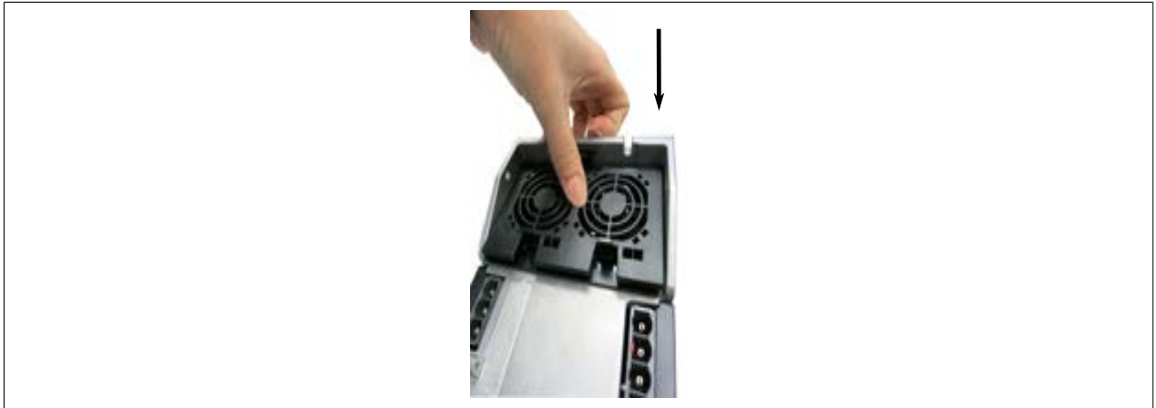
Figure 89: Installing the fan module
