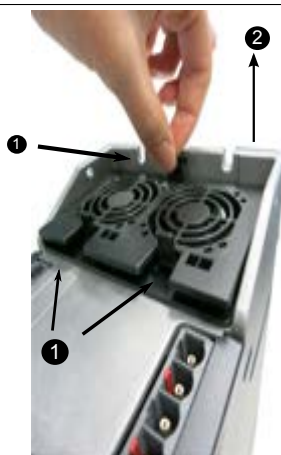
Figure 88: Removing the fan module
