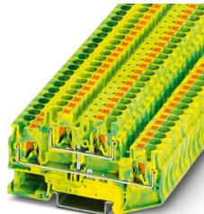
接地端子，接线方式：直插式连接，第一和第二层，横截面：0.2 mm<sup>2</sup> - 6 mm<sup>2</sup>，安装方式：NS 35/7,5，NS 35/15，颜色：黄绿相间
