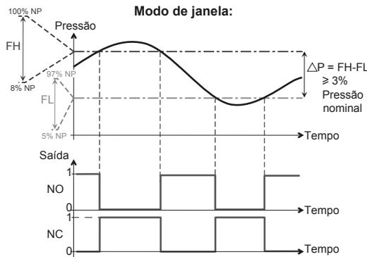
O modo de comutação da janela é normalmente utilizado para as "aplicações de regulação de pressão"
