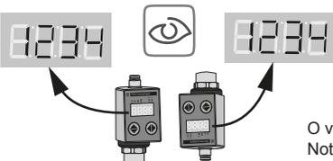
O visor pode ser invertido para ser adaptado ao posicionamento do produto (ver o menu de configuração diS). Nota: pode ser mais fácil inverter o visor antes da montagem.
