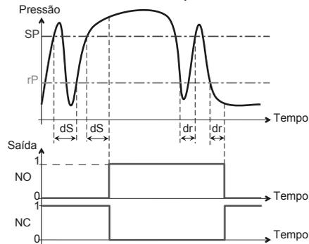
O atraso de tempo (ver os menus dS e dr) é normalmente utilizado para filtrar as pressões rápidas transitórias. A saída só comuta após um tempo "dS" e "dr" ajustável de 0 a 50s
