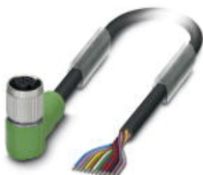
センサ/アクチュエータケーブル, 12-極, PVC, 黒RAL 9005, 片側フリー, 上 ソケット アングル M12 SPEEDCON, Aコーディング, ケーブル長: 10 m
