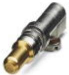
Power-Kontakt, für D-SUB-Kombinationseinsätze, Schraubanschluss, Stift, gerade, Bemessungsstrom 20 A, vergoldet
