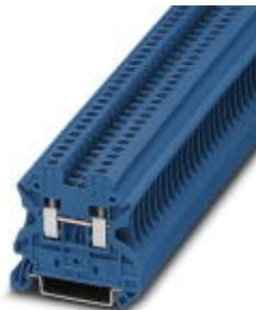
Blocs de jonction simple, tension nominale: 1000 V, intensité nominale: 24 A, type de raccordement: Raccordement vissé, nombre de connexions: 2, section : 0,14 mm<sup>2</sup> - 4 mm<sup>2</sup>, AWG: 26 - 12, largeur: 5,2 mm, hauteur: 46,9 mm, coloris: bleu, type de montage: NS 35/7,5, NS 35/15
