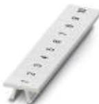
Repérage ZB, Rubans, blanc, repéré, impression longitudinale: numérotation continue 1 ... 10, 11 ... 20, etc. jusqu'à 491 ... 500, type de montage: encliquetage dans la rainure de repérage élevée, pour bloc de jonction au pas de : 5,2 mm, surface utile: 5,15 x 10,5 mm
