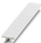
Repérage ZB, à commander : par bandes, blanc, impression selon les indications du client, type de montage: encliquetage dans la rainure de repérage élevée, pour bloc de jonction au pas de : 5,2 mm, surface utile: 5,15 x 10,5 mm
