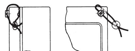
1. Rechte obere Deckelschraube ersetzen durch beiliegende Plombierschraube (mit Querloch)
