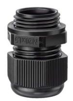
Kabelverschraubung Formstoff für Positionsschalter, M20x 1,5 für Leitungsdurchmesser: 5-13 mm
