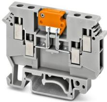
刀闸分断接线端子，标称工作电压: 630 V，额定电流: 16 A，接线方式: 螺钉连接，接线容量: 0.2 mm<sup>2</sup> - 6 mm<sup>2</sup>，安装: NS 32，NS 35/7,5，NS 35/15，颜色: 灰色
