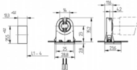
L1-4: Nella determinazione definitiva della distanza dei fori si deve di volta in volta tener conto delle dimensioni della lampada e dell'apparecchio di illuminazione.
