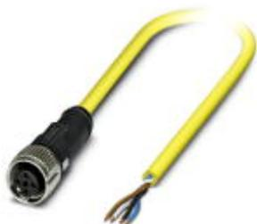
Sensor-/Aktor-Kabel, 4-polig, PVC, gelb, freies Leitungsende, auf Buchse gerade M12 SPEEDCON, A-kodiert, Kabellänge: 10 m
