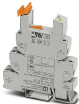
14 mm PLC-Grundklemme für hohe Dauerströme mit Schraubanschluss, ohne Relais- oder Solid-State-Relaisbestückung, zur Montage auf Tragschiene NS 35/7,5, 1 Wechsler, Eingangsspannung 24 V DC
