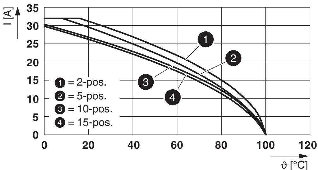
温度负荷曲线，适用于弹簧端子ST 4/1P.. 及ST 4/2P.. 所有插头型号SP 4/.... 温度负荷曲线通过标准曲线乘以系数0.8获得
