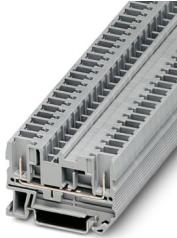
直通式接线端子，标称工作电压: 800 V，额定电流: 32 A，连接量: 2，接线方式: 直插式连接，第1层左边连接，额定接线容量: 4 mm<sup>2</sup>，横截面: 0.08 mm<sup>2</sup> - 6 mm<sup>2</sup>，安装方式: NS 35/7.5，NS 35/15，颜色: 灰色
