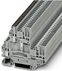
双层接线端子，\*使用的插头决定电流和电压。, 带等电位连接, 标称工作电压: 500 V, 额定电流: 24 A, 接线方式: 螺钉/插拔式连接, 额定接线容量: 2.5 mm<sup>2</sup>, 横截面: 0.14 mm<sup>2</sup> - 4 mm<sup>2</sup>, 安装方式: NS 35/7,5, NS 35/15, 颜色: 灰色
