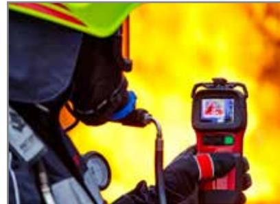
La **plage de températures** d'un instrument est également déterminante. Toutes les applications ne nécessitent pas une plage de mesures couvrant des températures extrêmes. En effet, plus la plage de températures est étendue, plus les capteurs sont coûteux, ce qui a une incidence sur le prix de l'instrument.
